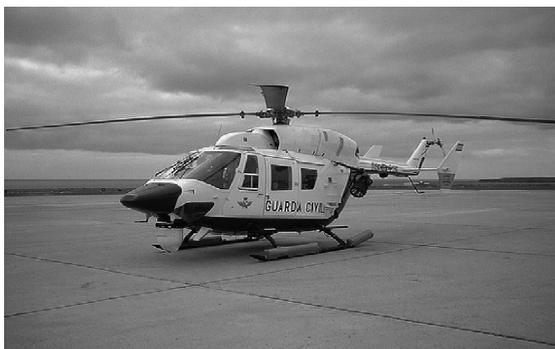
*Helicóptero BK-117, dotado de FLIR debajo del morro*
