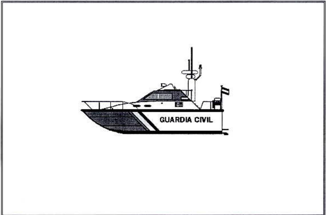
**Tipo de embarcación:** Es una embarcación tipo lancha rápida con casco, cubierta y cabina, diseñada y construida en plástico reforzado con fibra de vidrio (PRFV), en construcción sandwich y propulsión diésel.
