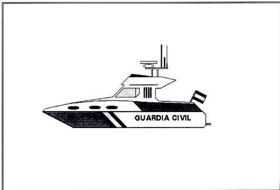
**Tipo de embarcación:** Es una embarcación tipo lancha rápida con casco de poliéster reforzado con fibra de vidrio y Kevlar, con forma de "V" y propulsión diésel.
