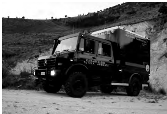
Laboratorio móvil UNIMOG (sobre chasis Mercedes) con capacidad para efectuar análisis en áreas tibias
